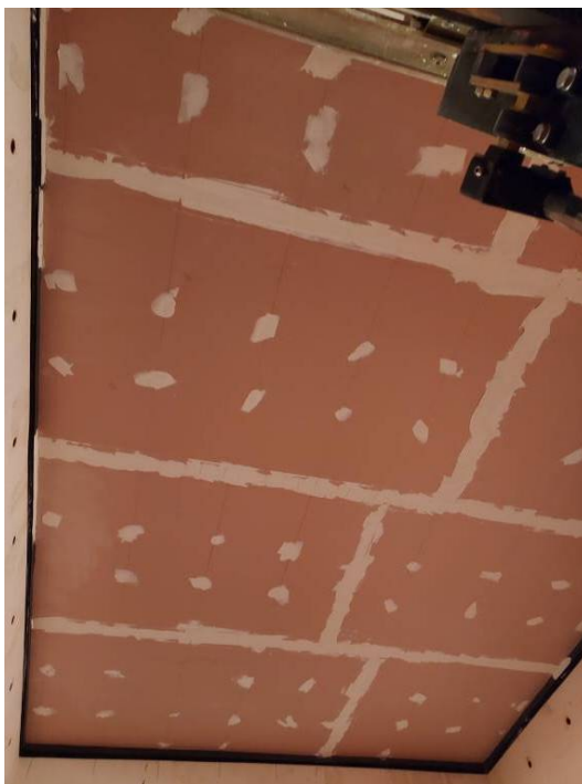
Vue de l'échantillon d'essai dans les salles acoustiques
